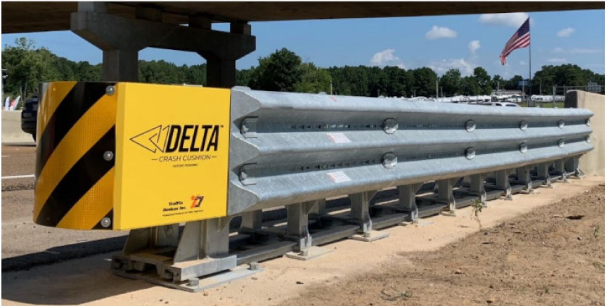
El DELTA® es un amortiguador de impacto redireccionable no traspasable, esta diseñado para condiciones de tráfico unidireccional y bidireccional, es de soporte independiente y no requiere estar unido al objeto que resguarda; se puede instalar sobre superficies de concreto, asfalto o una mezcla de concreto y asfalto. Atenúa la energía cinética del vehículo que se impacta por medio de patrones de corte ubicados en los paneles laterales.
